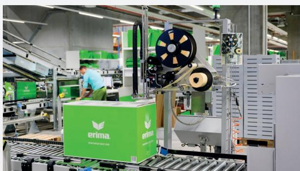
Une fois le paquet fini, il passe à l'étiquetage. Le système sait automatiquement où la marchandise doit être livrée et munit le paquet de l'adresse exacte.
