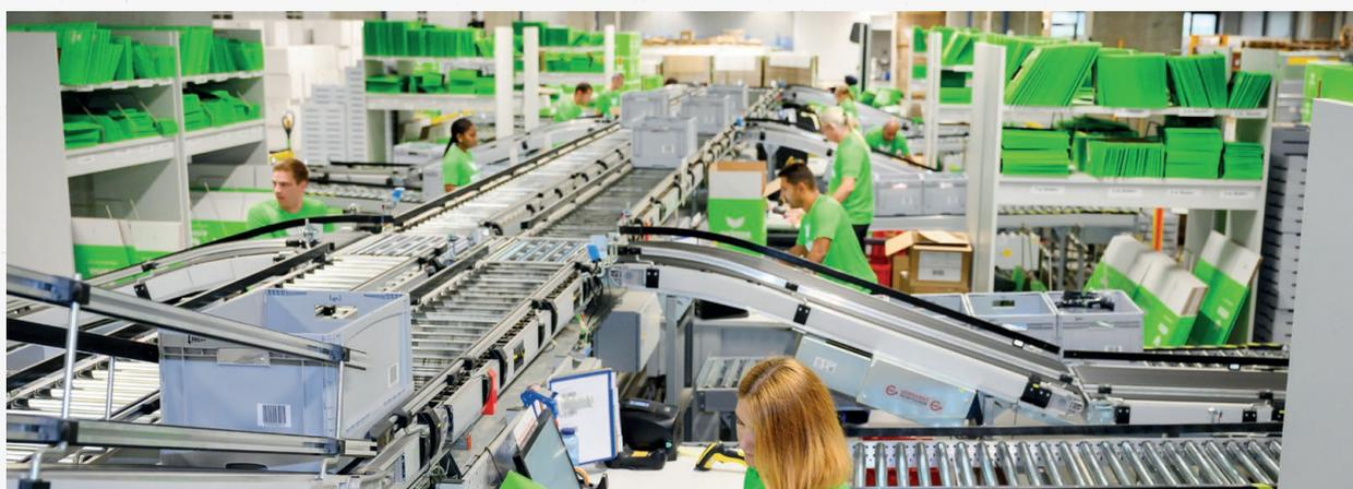
Les caisses dont la commande a été traitée vont automatiquement au contrôle final. Nos employés y contrôlent l'exactitude et l'exhaustivité des contenus. Les marchandises provenant du rayonnage grande hauteur arrivent également ici. Ensuite, les commandes sont disposées dans nos cartons ERIMA verts.
