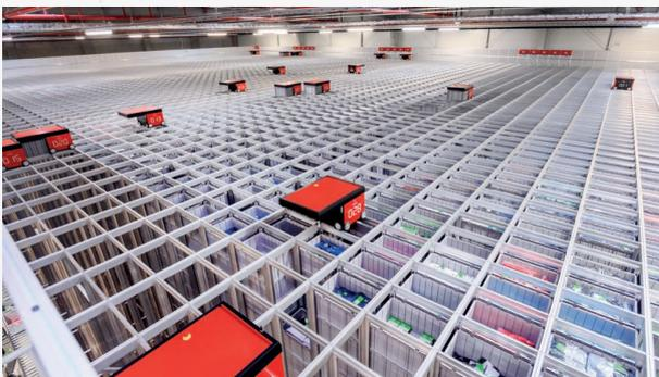
Notre concept : notre système autonome desservi par plus de 50 robots. Ces derniers gèrent le transit total de 150 000 caisses avec plus de 3,5 millions de produits.
