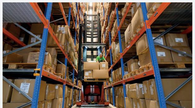
Outre le système autonome, le centre logistique comprend une autre zone de stockage. Le rayonnage de 20 m de hauteur accueille les marchandises encombrantes et volumineuses telles que les ballons, les sacs et les autres accessoires ne rentrant pas dans des caisses.
